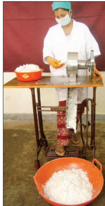
चित्र 8 यंत्र से नारियल अष्टी का कर्तन
