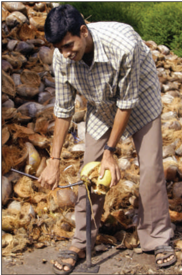
चित्र 3 नारियल छिल्का निकालता है
