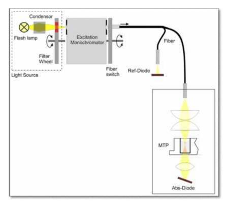
Optical System Absorbance Infinite M200 PRO
